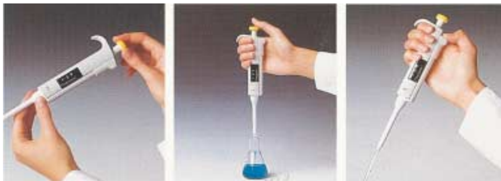
Εικόνα 1.25: Ρύθμιση και χειρισμός αυτόματης πιπέττας.
