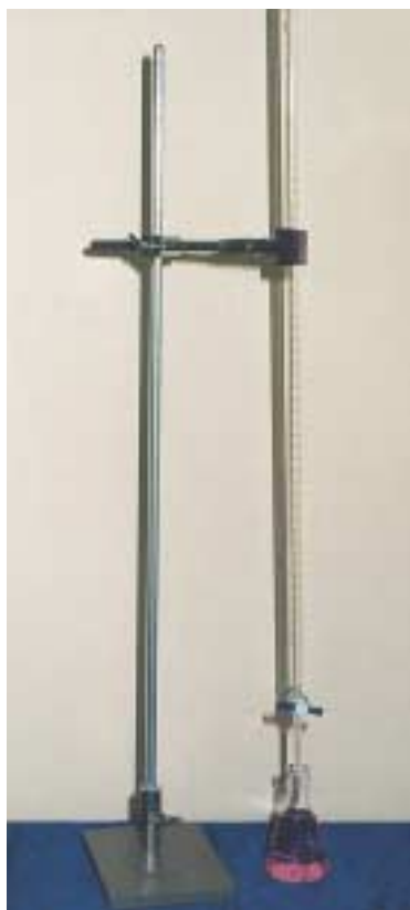
Εικόνα 1.29: Προχοΐδα τοποθετημένη σε στατώ.
