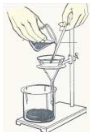
Εικόνα 1.34: Απεικόνιση τρόπου διήθησης.
