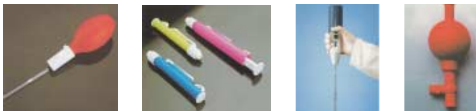
Εικόνα 1.22: Αναρρόφηση υγρού με τη βοήθεια ειδικών εξαρτημάτων.
