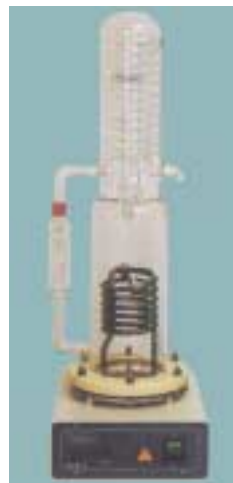
Εικόνα 1.15: Συσκευή απόσταξης νερού.
